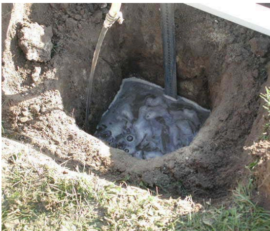
Hullet holdes vandfyldt med 0,20 m vand i ca. 30 min. I våde perioder (med meget regn) kan dette nedsættes til 15 min.
