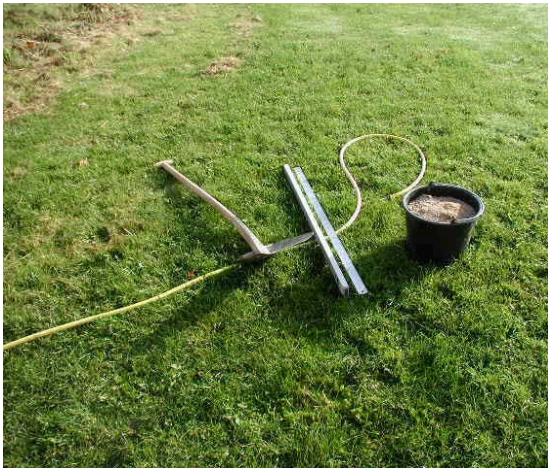
Udstyr til infiltrationstest: Haveslange, skovl grus, retskinne og målestok / målebånd.
