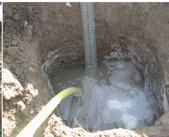
Synkehastighed måles. Hvis synkehastigheden er næsten konstant kan infiltrationstesten begynde.
